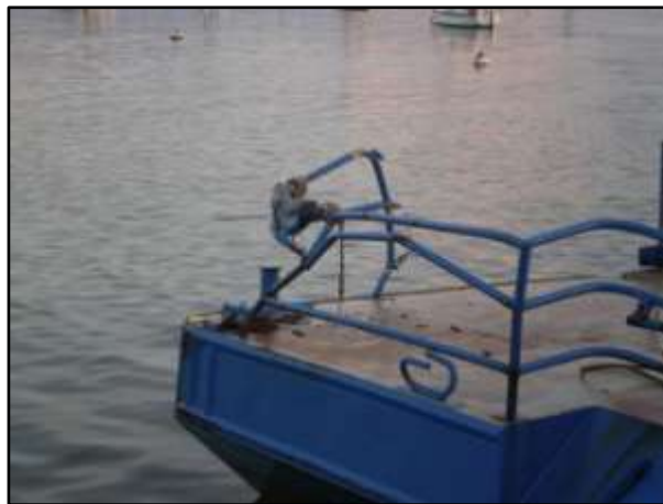
Rambardes pliées à l'avant tribord de la barge.
