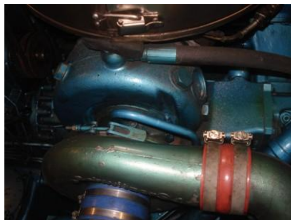
Moteur Beaudoin 12M26SR : le turbo GARRETT avec son tuyautage d'arrivée d'huile de lubrification des paliers.
