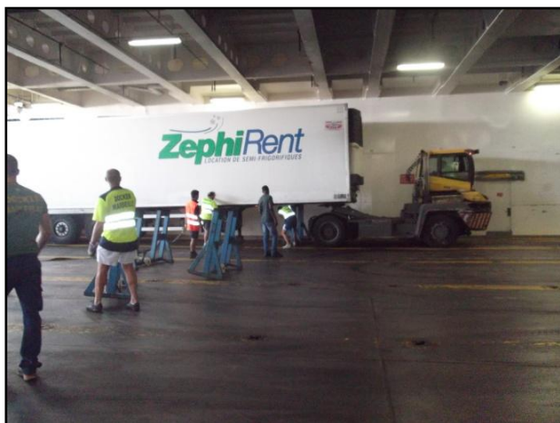
Mise en place d'une remorque par un tracteur « Douglas » au pont 5 arrière bâbord.
