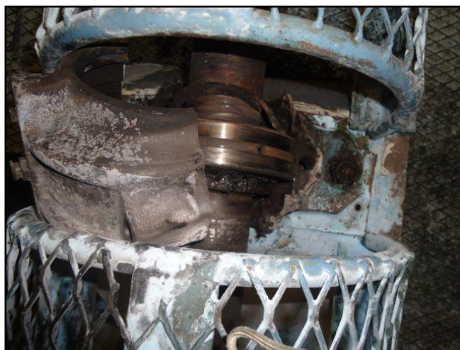
Palier n° 9, dernier tronçon de l'arbre tribord.
