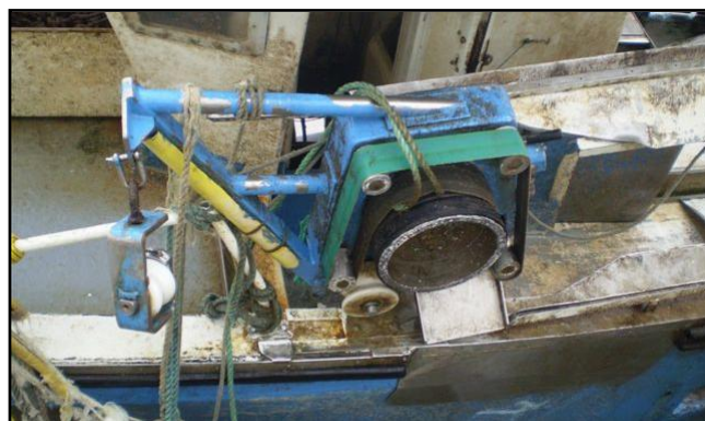
Après renflouement, vue de l'orin pris dans le vire casiers.
