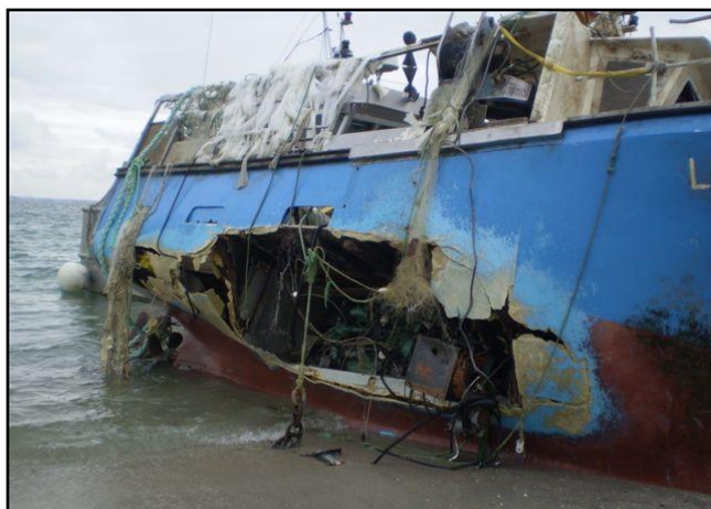
État du navire échoué après l'opération de renflouement.
