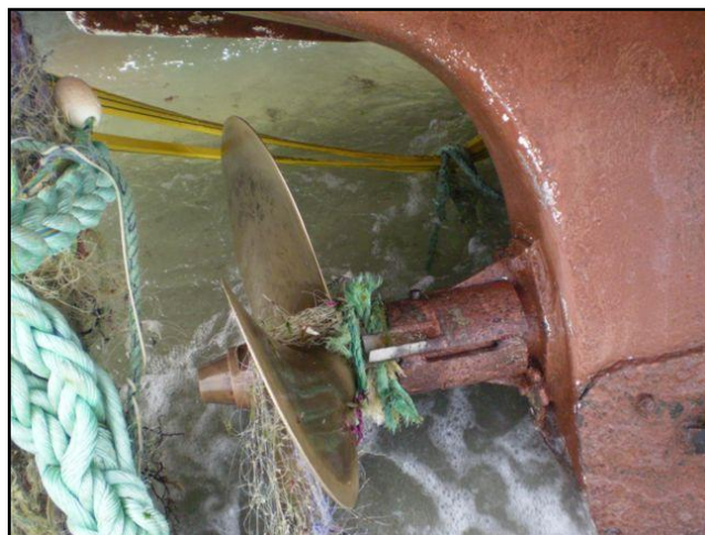
Orin de la filière des casiers pris dans le coupe-orin de l'hélice.
