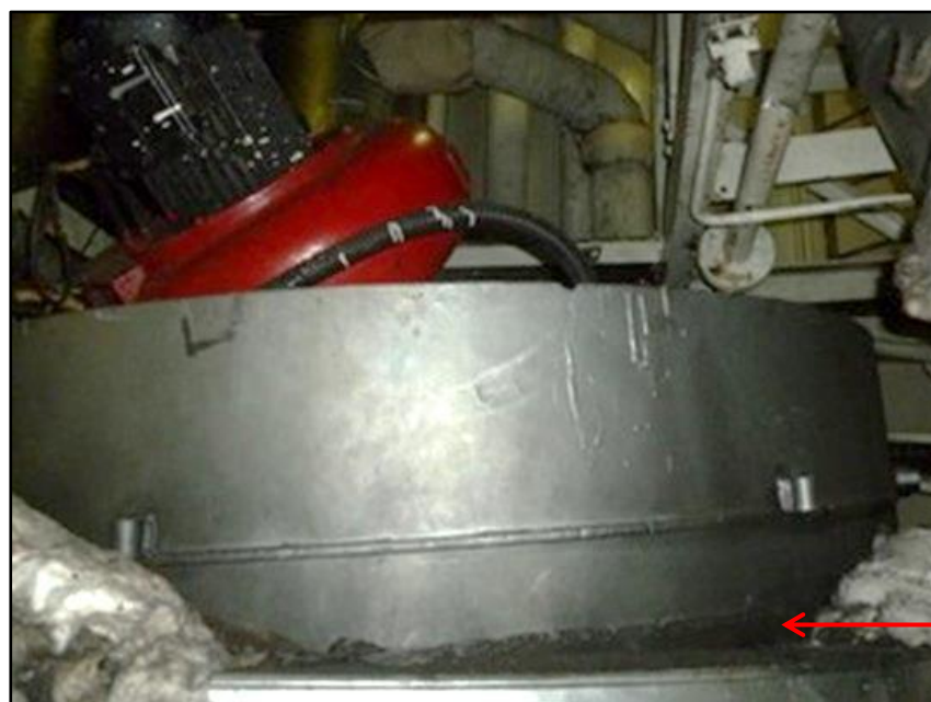
Le haut de la chaudière après l'explosion, avant démontage (crédit Sea Tanker)
