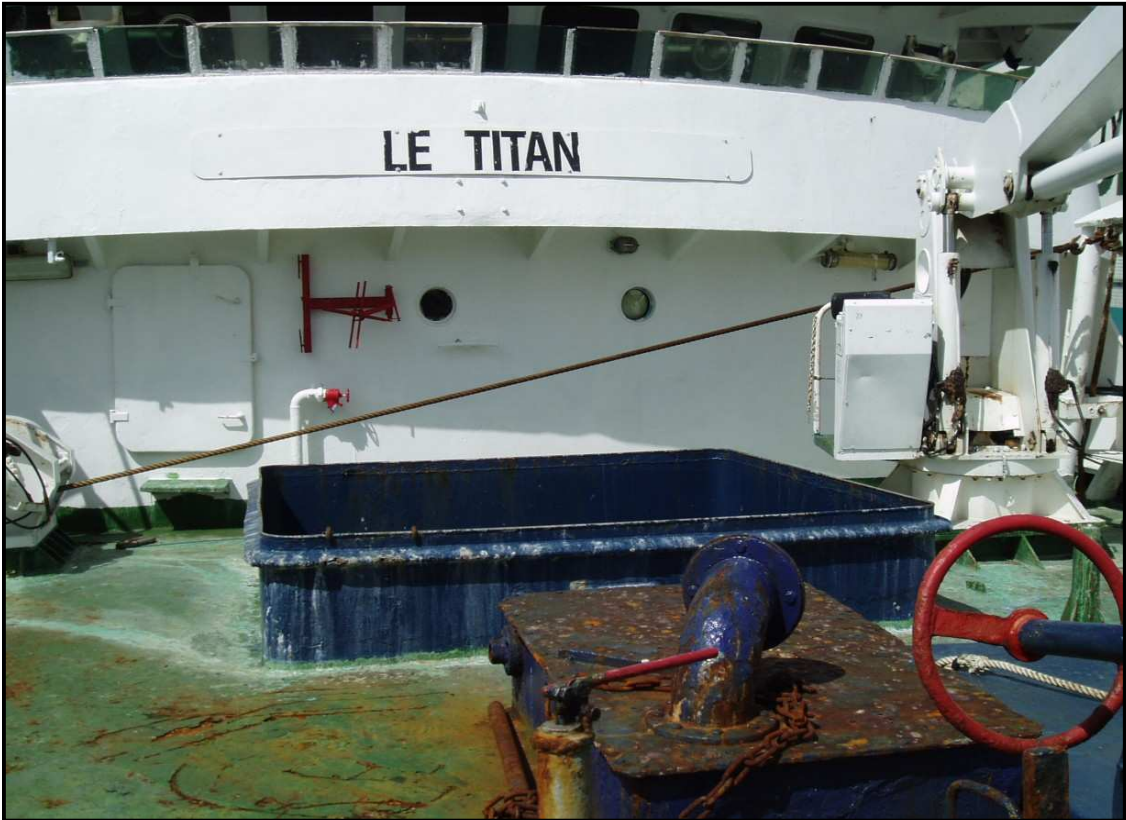
Entrepont - Panneau avant par lequel l'ammoniac s'est échappé
