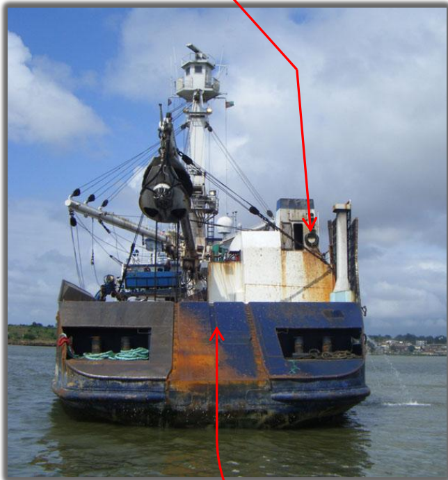
Emplacement du skiff lors du remplissage de son réservoir. Il est alors disposé sur le filet qui occupe la plus grande partie de la plage arrière.
