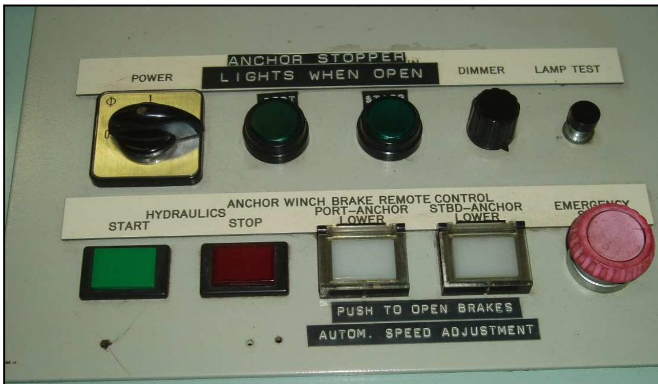
Dispositif de commande à distance de mouillage des ancres
