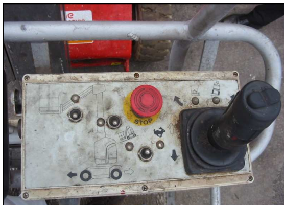
Vue du poste de commande (manche manipulateur et boutons de commandes) dans le panier.
