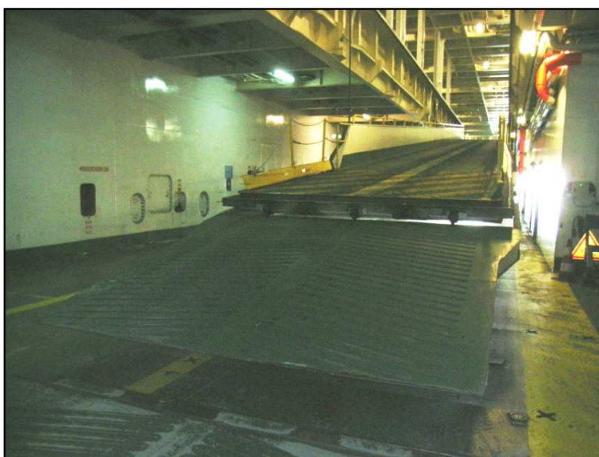
Vue d'une rampe, de sa bavette (flap) et du décrochement.
