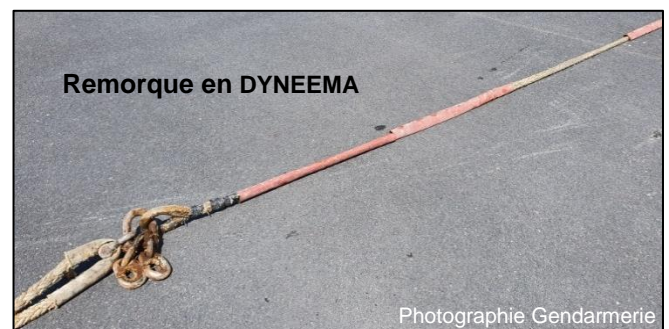
Photographies de l'extrémité de la remorque récupérée sur l'épave lors du renflouement
