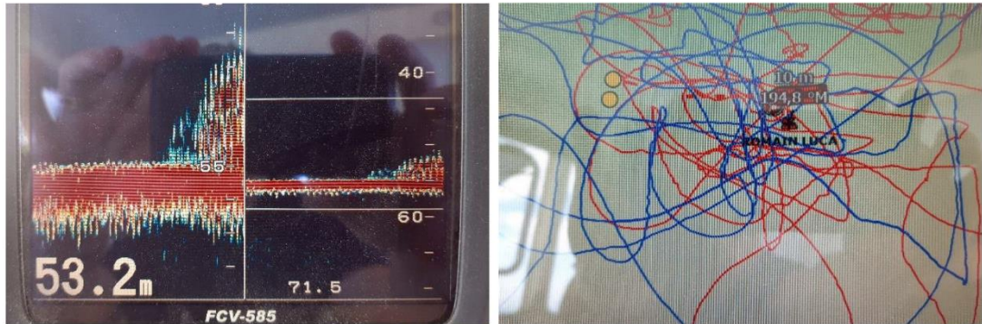
Figure 12: Détection de l'épave au sondeur de bord
