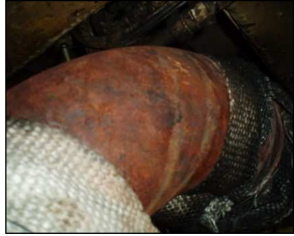
Gainage de câbles électriques endommagé et présence de raccords de tuyaux hydrauliques à proximité du collecteur d'échappement non calorifugé
