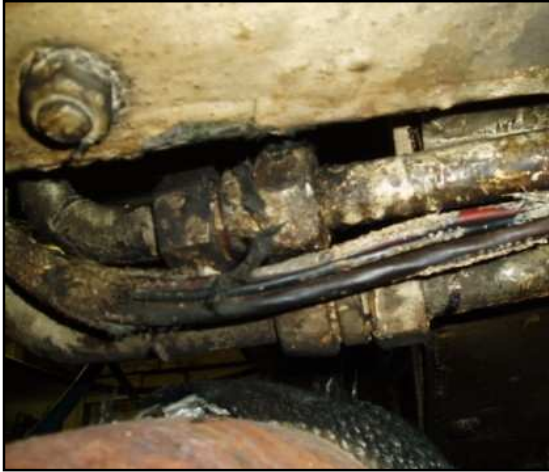
Gainage de câbles électriques endommagé et présence de raccords de tuyaux hydrauliques à proximité du collecteur d'échappement non calorifugé
