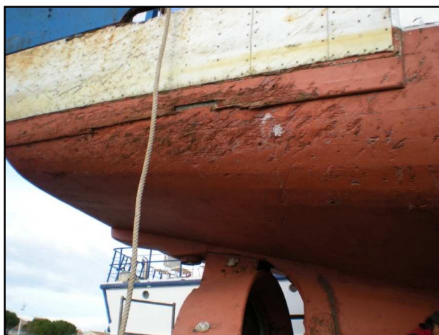
Photo 1, mars 2009 : Soufflage tribord et zone d'impact du panneau.
