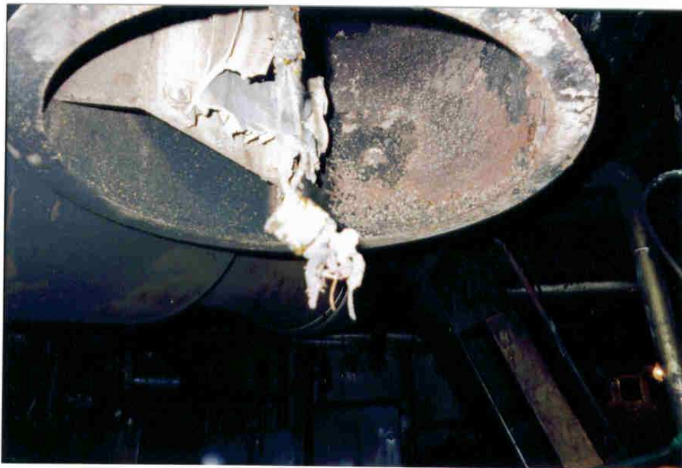
Virole support du ventilateur machine.
