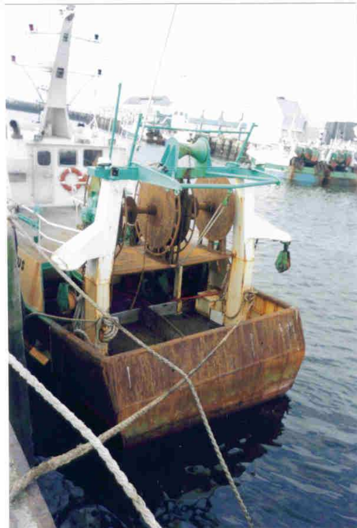
Forte corrosion du tableau arrière.
