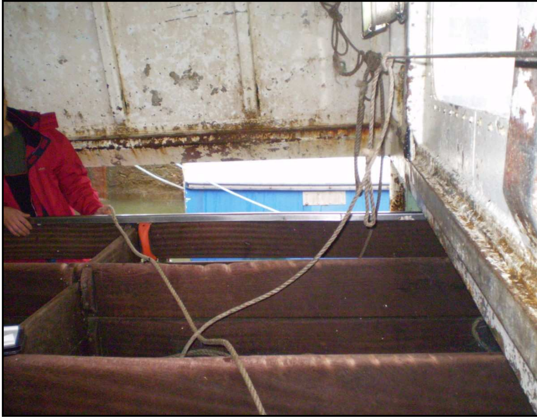
Orin passé au mécanicien pour amarrage aux gueuses. Les planches sont usées par les frottements des cordages.
