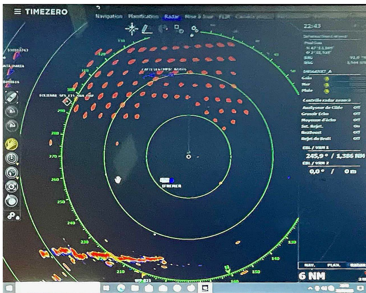
Figure 5 : Image radar interfacée par le logiciel de carte TimeZero, dans l'axe de la vedette SNS PIERRE BOUGUER, cap au 196°, échelle 6 milles, avant d'entrer dans le champ éolien par le nord. L'alidad sur le cercle de distance des 6 milles. Cliché pris par le BEA mer le 26 juin 2025.
