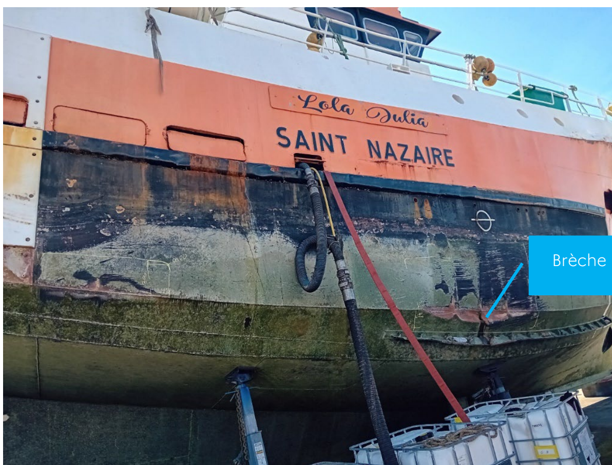
Figure 6 : Vue du bouchain tribord avec les tôles froissées et la brèche au droit de la marque de franc bord
