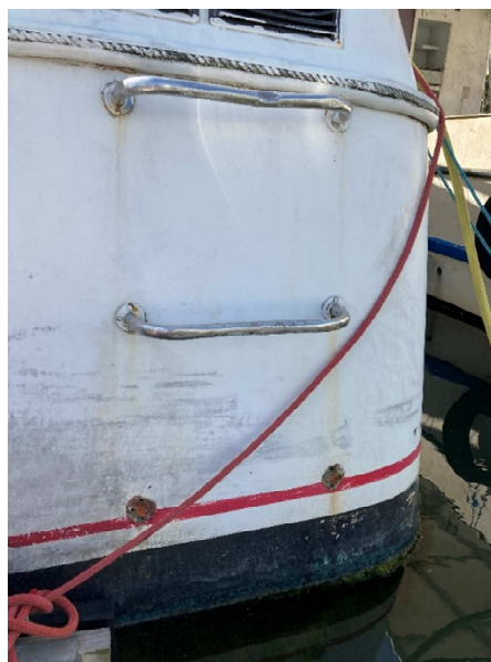
Figure 5: Détail des barreaux manquants et endommagés
