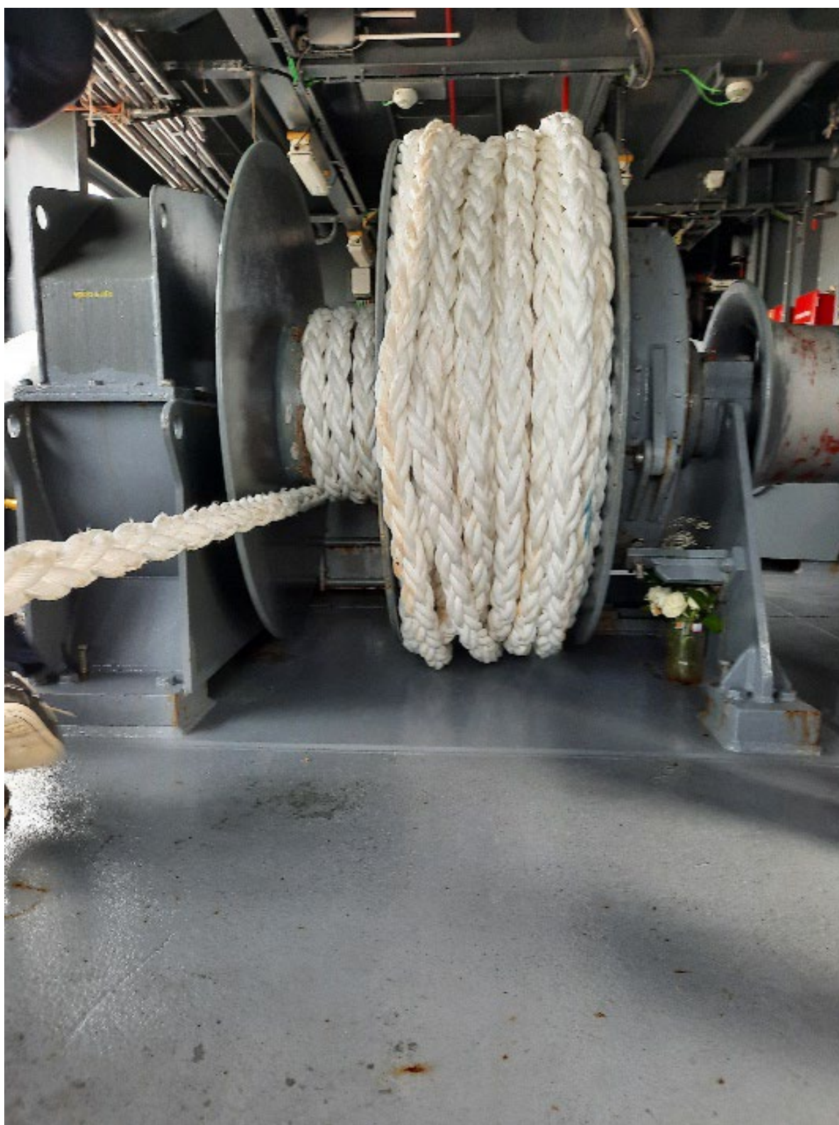
Figure 8 - Le treuil arrière avec à gauche du cliché le tambour de force et à droite le tambour de stockage
