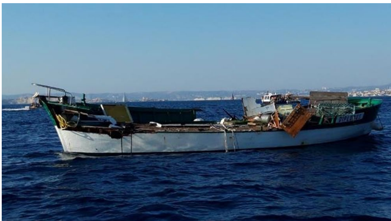
Figure 7: Vue du DIPLODUS côté bâbord avant, après avoir été traversé par le SKY FALL. Source photographe amateur à comparer à la photo du navire avec ses superstructures avant accident en début de rapport (Figure 4).
