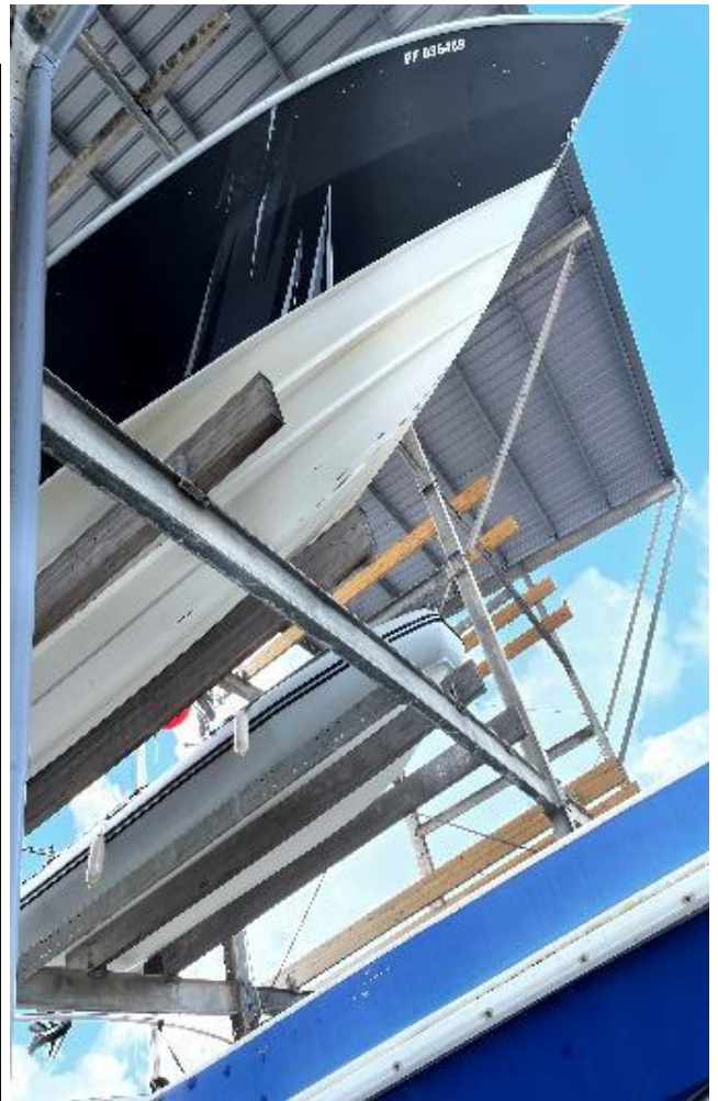
Figure 9 – L'étrave du Rum'N Fishing, côté tribord, quasi intacte.
