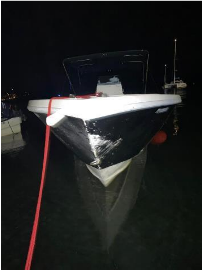
Figure 8 - L'étrave du Rum'N Fishing, peu de temps après l'accident pris depuis le ponton de la Française. Le revêtement côté bâbord est délaminé, l'anneau de remorquage est déformé sur tribord.
