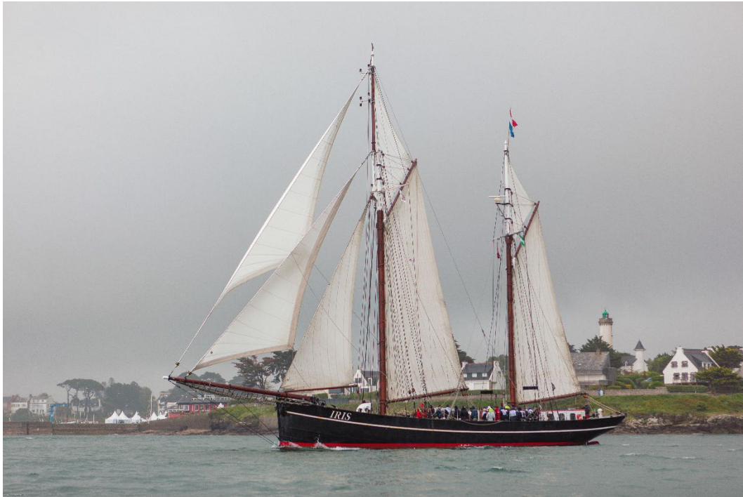
Fig.9 L'Iris, sistership de DE GALLANT exploité en navigation charter a grée ses voiles d'avant sur enrouleur et conservé le gréement original de ketch. (Photo DR)
