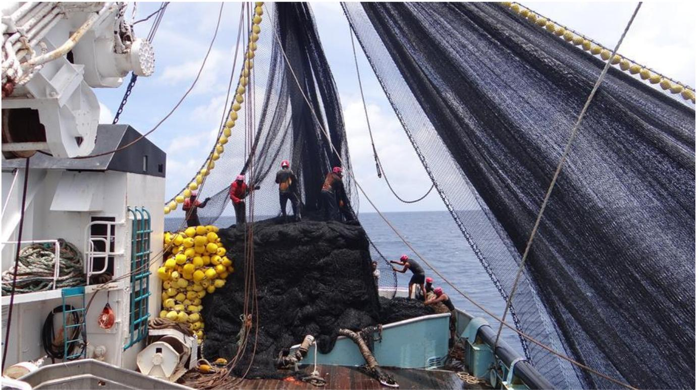
*Figure 4 - Des membres d'équipage d'un senneur (autre que le Gueotec) procédant au rangement de la senne, vue de l'avant vers l'arrière. À tribord, la ralingue supérieure munie de flotteur (côté liège), à bâbord, la ralingue de fond dite côté chaîne. Source : BEAmer*
