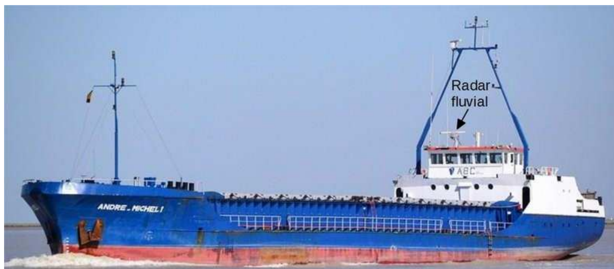
Navire ANDRE-MICHEL 1 en configuration mer (la passerelle, le mât principal et le mât avant sont déployés)
