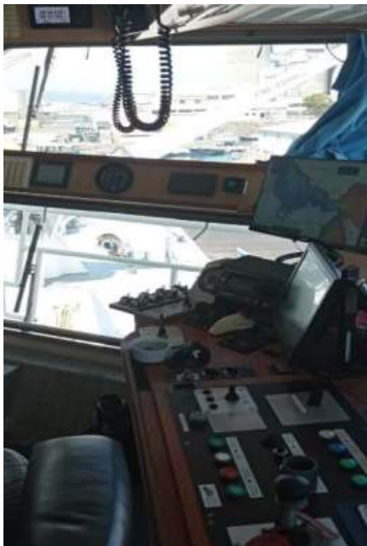
Figure 6- Poste de commande de la passerelle
