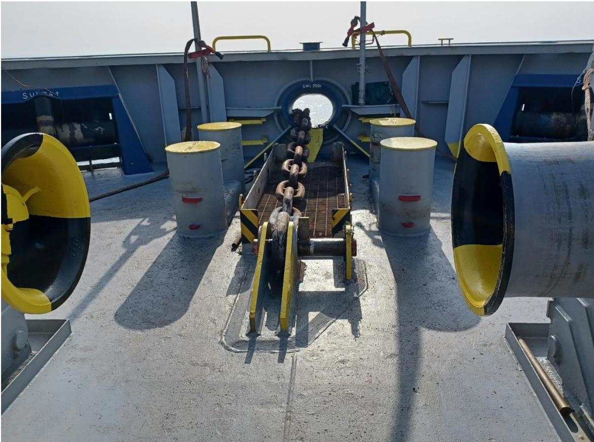
Figure 2 - Chaîne de remorquage connectée au "Smit Bracket"
