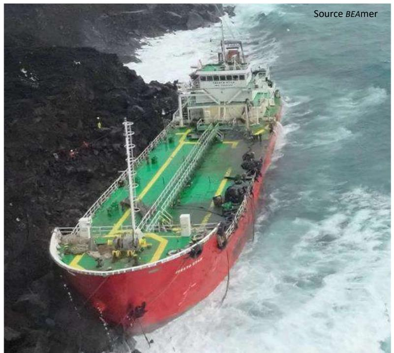
L'interdiction de se réfugier à quai à Port-Louis, un appareillage un peu tardif et une route trop éloignée de la côte, ont exposé aux éléments un navire sur ballast, offrant une forte prise au vent et disposant d'une faible puissance de propulsion.
