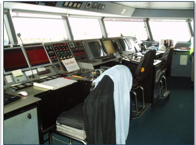
La timonerie panoramique couvre toute la largeur du pont passerelle. Le poste de conduite est ergonomique. Deux ailerons, dont les fenêtres latérales sont ouvrantes, prolongent la passerelle.
