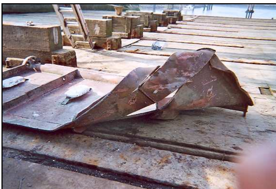
Gouvernail du navire démonté.
