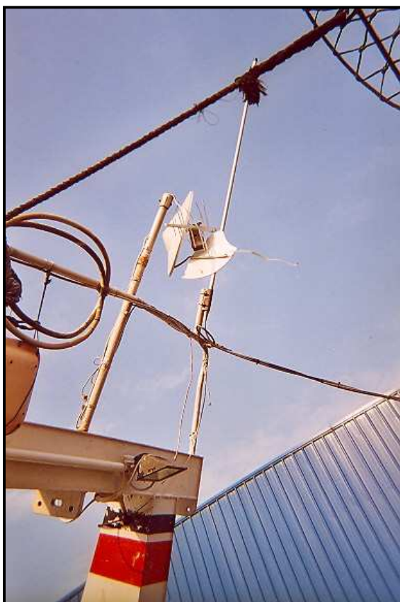
Antennes fixées sur le portique renversé.
