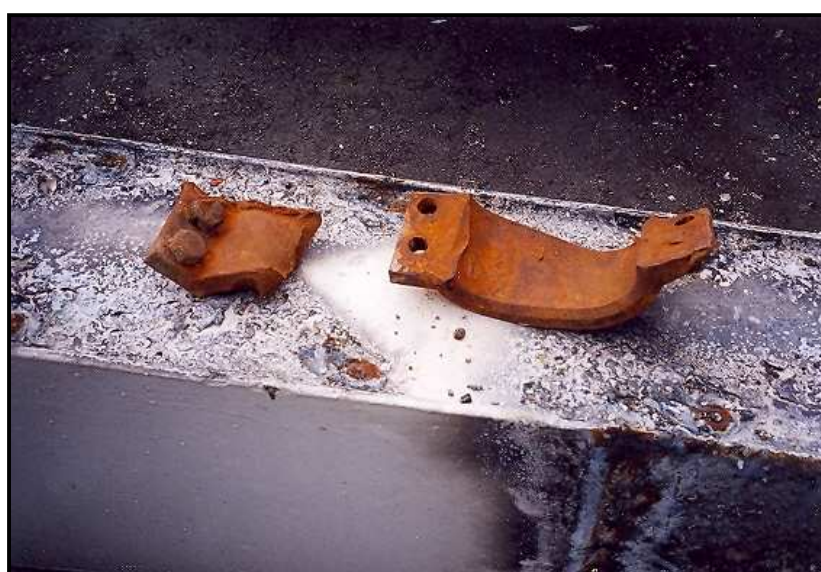
Pièces de fixation du gouvernail trouvées dans le bulbe du PEYO YAVOROV .
