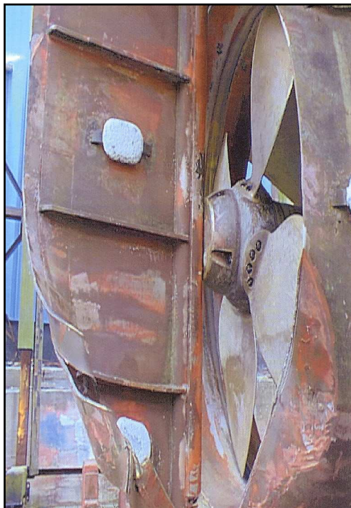
Gouvernail tordu au contact de l'hélice et de la tuyère.
