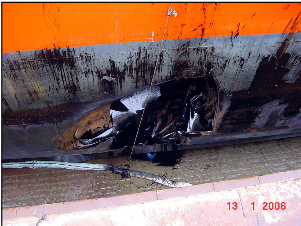
Brèche occasionnée par le bulbe du SIGMAGAS dans le ballast FO n°1 bâbord.
