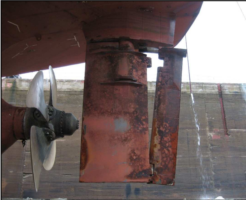
Navire en cale sèche, vue du gouvernail : le volet articulé ne tient plus que par la charnière inférieure et sa transmission mécanique.
