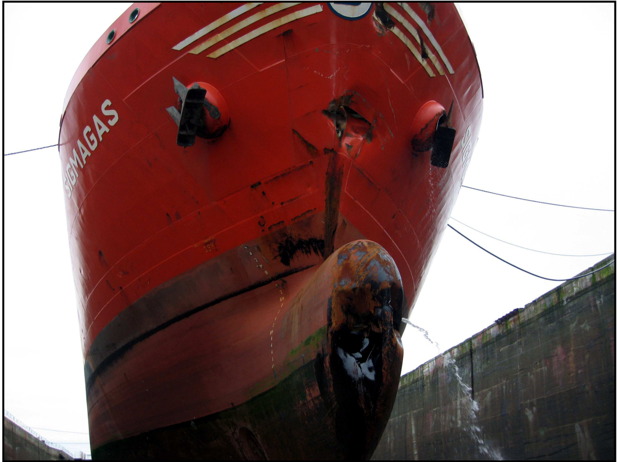
Étrave et bulbe du SIGMAGAS endommagés après l'abordage, avec des traces de fioul provenant du HAPPY BRIDE .
