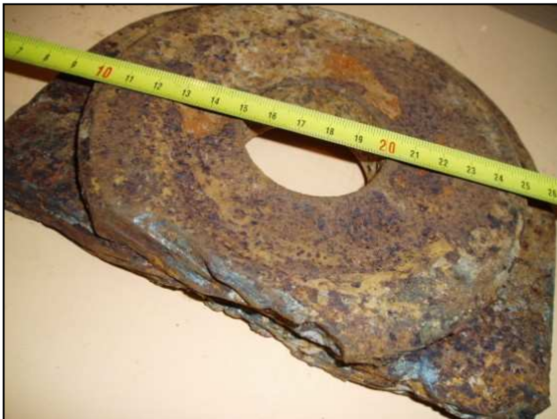
Plaque support inférieure. Zone de corrosion / érosion au contact avec l'axe.
