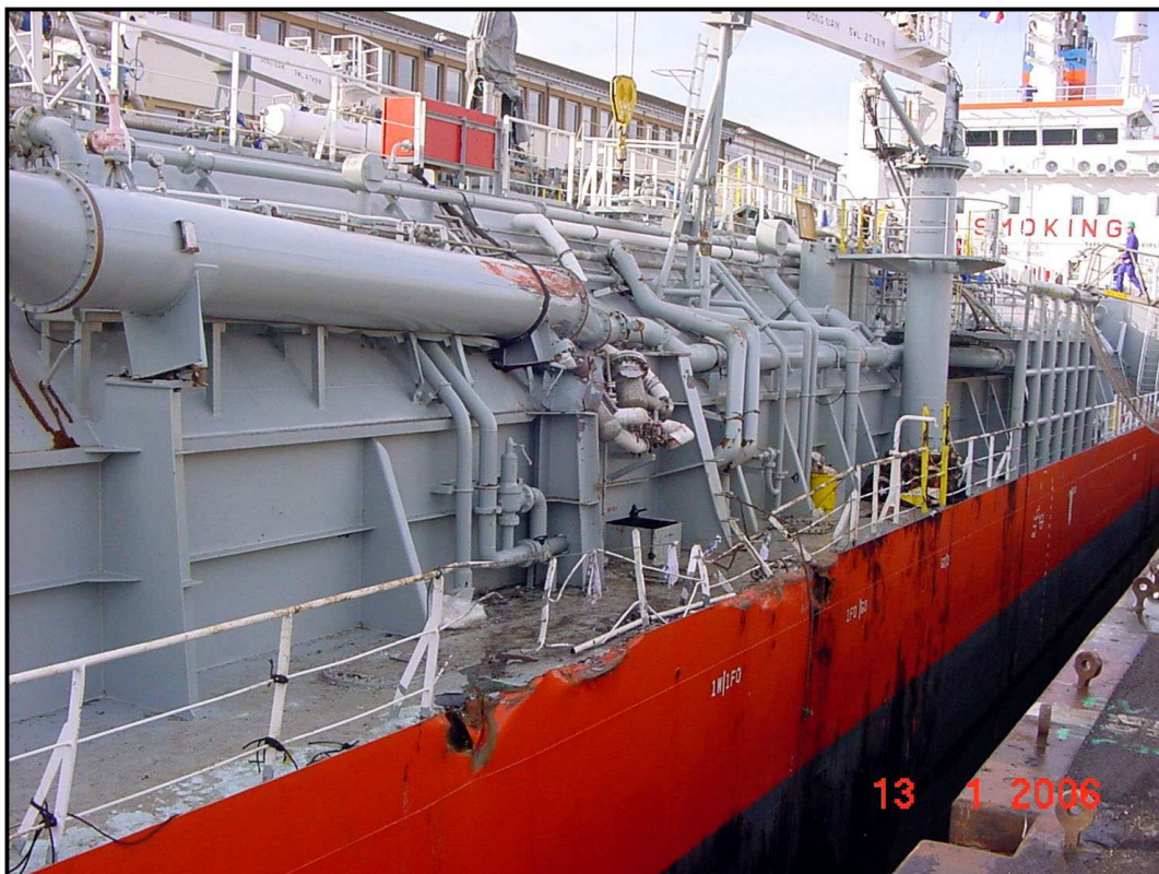
Bordé bâbord : dommages aux batayoles et tuyautages de condenseur.
