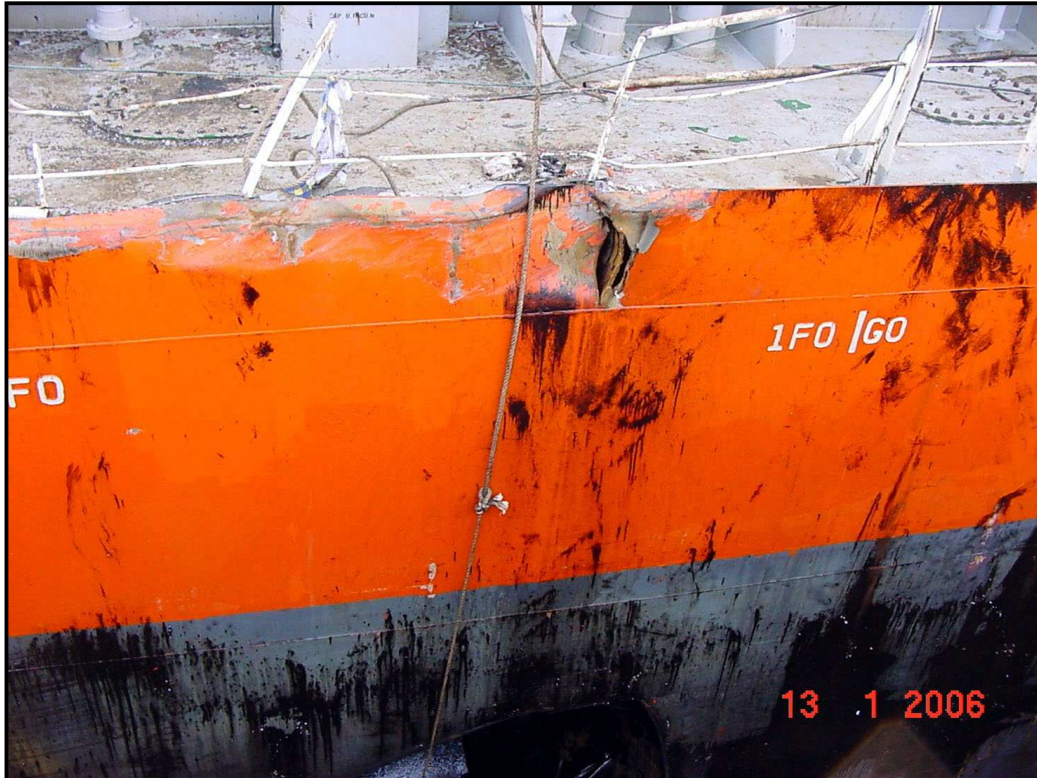
Bordé bâbord : zone d'impact de l'étrave du SIGMAGAS.
