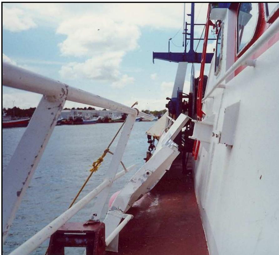
Partie enfoncée et redressée de l'avant vers l'arrière
