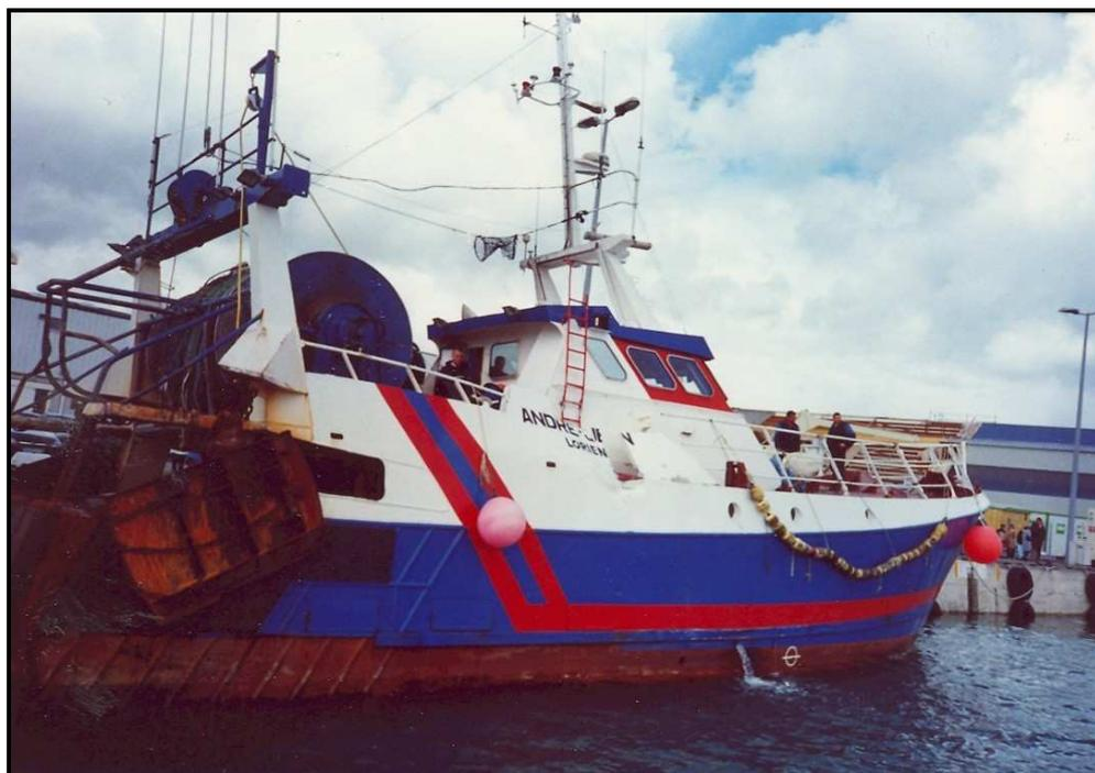
Autre photographie prise de l'extérieur. Le point de choc a vraisemblablement eu lieu à l'endroit de la découpe puisque l'échelle en face, fixée sur la timonerie, est également pliée à la hauteur de la lisse.
