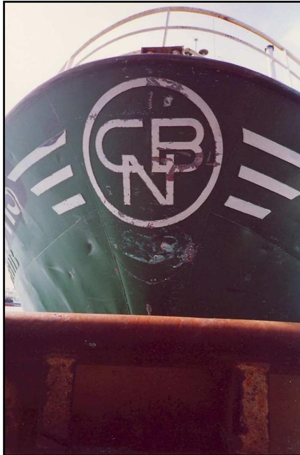
Étrave du chalutier Tour d'Auvergne (les traces se situent sous les initiales et à côté sur tribord).
