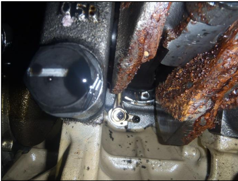
Corrosion sur moteur bâbord (carter inférieur déposé).
