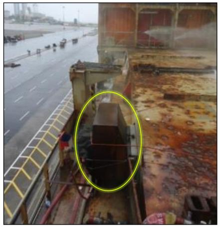
Adaptateur sur ventilation cale pour injection mousse
