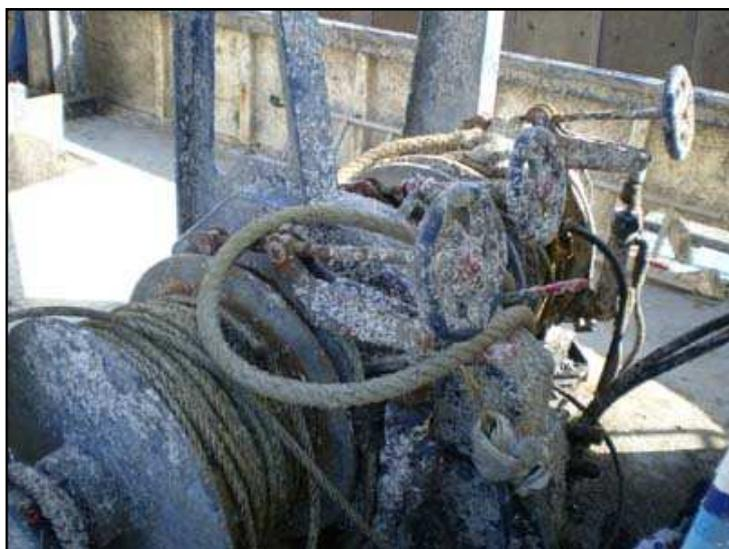
Un portique arrière supporte deux enrouleurs entraînés par un moteur hydraulique indépendant installé en 2002.
