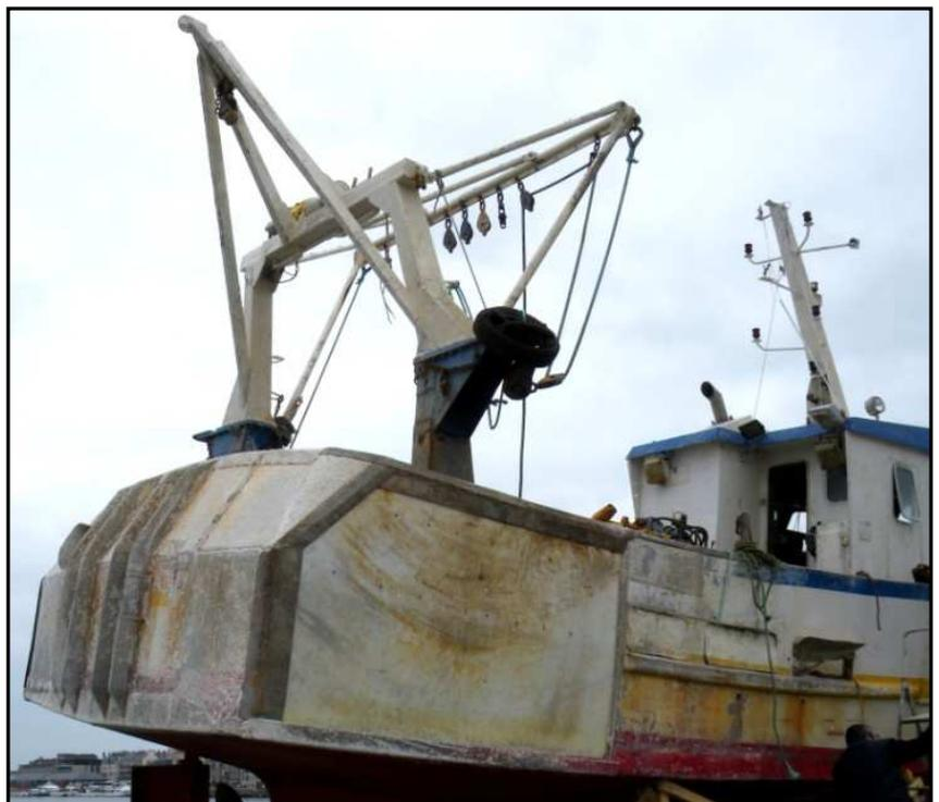
Ce matériel entraîne la modification de la technique employée pour ramener par les flancs, via les boucles d'oreille, les dragues, et les présenter ensuite au tableau arrière, suspendues à la caliorne. Ceci se traduit par un déplacement transversal sur bâbord du point d'application du poids suspendu, avec en outre un risque important de s'accrocher au roulis.
