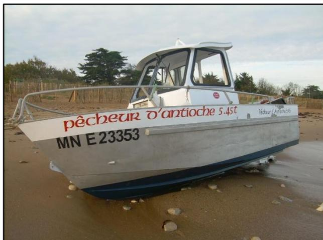
*OCTOPUSSY VII* : vedette en alliage léger type Pêcheur d'Antioche (immatriculée MN E23353), construite en 2010 – L : 5,45m – Moteur hors-bord de 66 kW.
