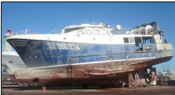
Chalutier pêche arrière en acier, superstructures en alliage d'aluminium, construit en 2004 en Espagne.
