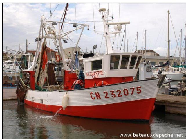
*ALGWASTRE* : navire en bois construit en 1974 (immatriculé 232 075 à Caen) – L : 9,54 m – Jauge : 8,07 UMS – Propulsion : 92 kW.
