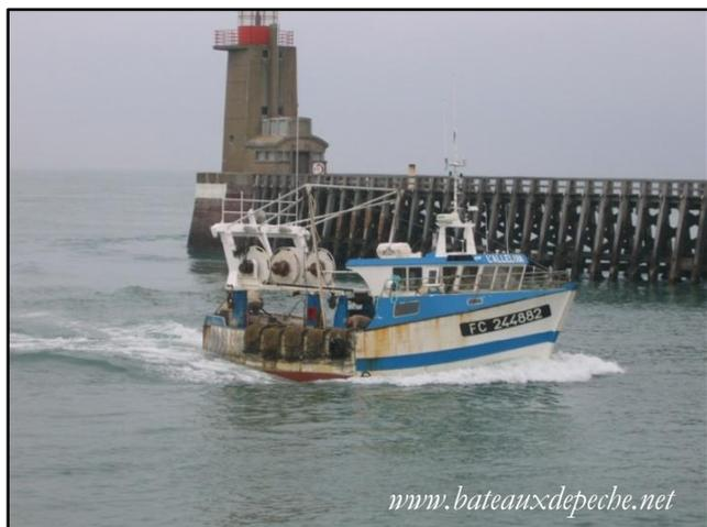
*L'ALLELUIA* : navire en bois construit en 1974 (immatriculé 244 882 Dieppe) – L : 12,60 m – Jauge : 17,01 tx – Propulsion : 160 kW.
