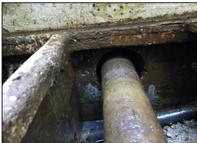
La cloison de la cale à poissons n'étant pas étanche au passage de la ligne d'arbre et du tuyau d'assèchement, le compartiment machine a été ensuite envahi.
